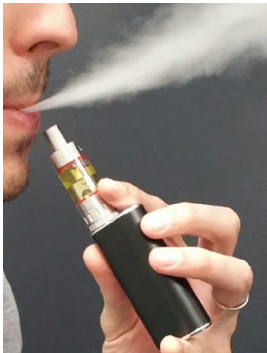
Figure 1 : photo d'une cigarette électronique complète (batterie et chambre de vaporisation).
